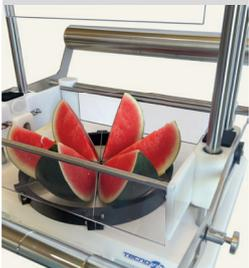
Nous remplaçons la lame de coupe de portions par la lame de coupe multiple.
