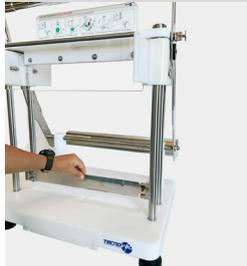
Colocamos la cuchilla de corte, deseada en el porta cuchillas.
