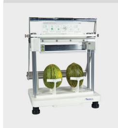
Procedemos a realizar el corte, accionando hacia abajo la palanca.
